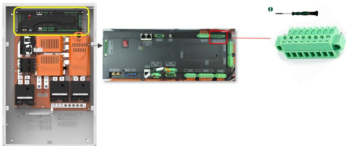
**Paso 3.** Pele los cables de los CT con una longitud de pelado de 0.32 pulgadas (8 mm).
