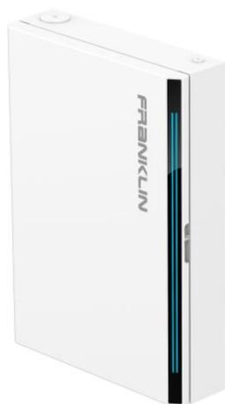
El aGate X controla el funcionamiento del sistema con un Sistema de Gestión Energética (EMS) incorporado, un módulo de distribución de energía, circuitos inteligentes y un módulo de comunicación, suministrando gestión y respaldo energéticos para cargas residenciales.
